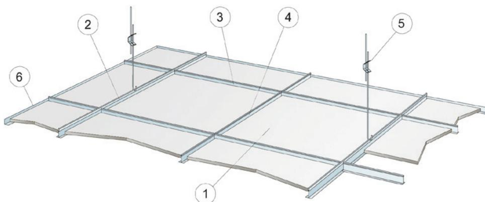
1. Панель **Ветонит Аква Файер** толщиной 8 мм
